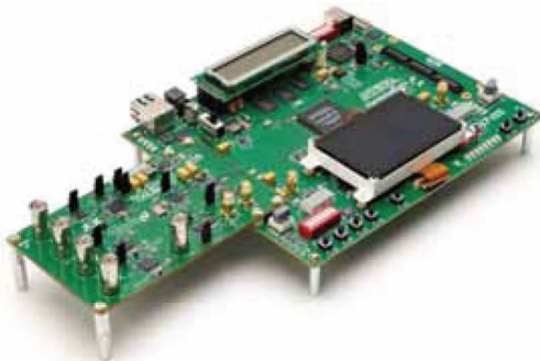
National 3G SDIデータボードを搭載したCyclone III 評価ボードです。
